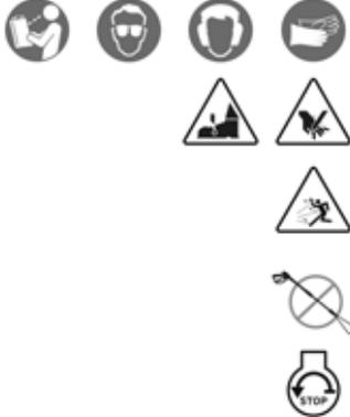
8. Dieser Aufkleber ist auf der oberen Abdeckung des Gehäuses angebracht. Das ist eine zentrale Stelle an der Maschine, die für den Bediener stets gut sichtbar ist, wenn er im Begriff ist, den Motor zu starten. Der Aufkleber fasst eine Reihe wichtiger Anweisungen für den Bediener zusammen:
